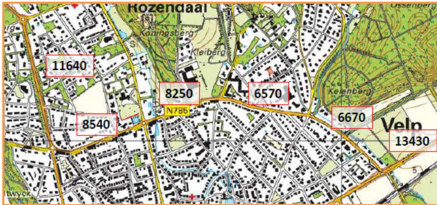
Fig. 5. Werkdagintensiteiten in 2019 (bron: prov. Gelderland). De Ringallee (8540 en 8250 mvt per werkdag) is aanzienlijk drukker dan de Beukenweg en Beekhuizenseweg. Dit kan te maken hebben met de vele sportvoorzieningen ten noorden van de weg, maar ook omdat het autoverkeer vanuit Velp meer op Arnhem e.o. gericht is dan op bestemmingen ten oosten van Velp.
